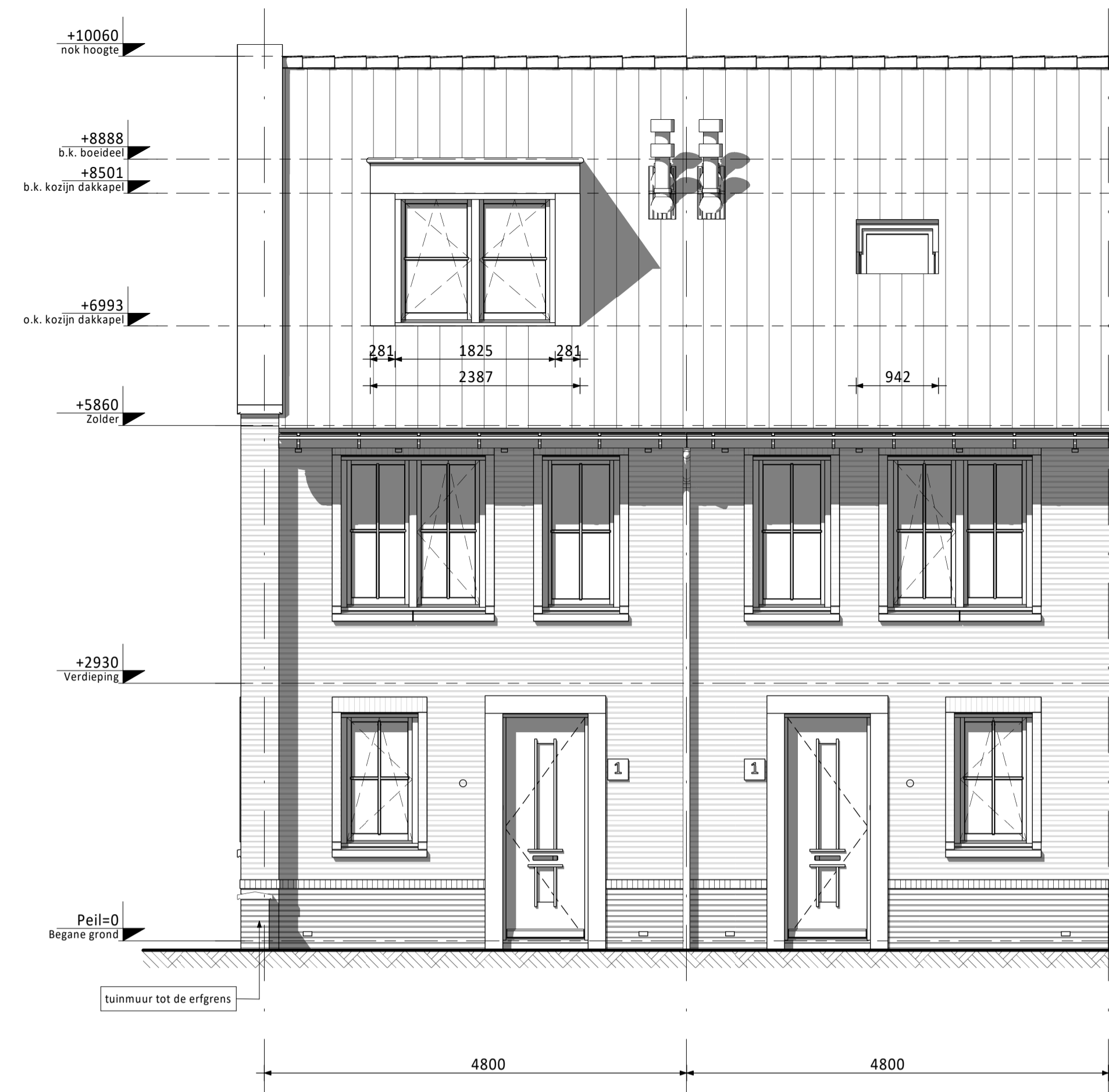
Voorgevel (as) • Dakkapel voorzijde (niet mogelijk bij bwnrs. 07 en 13) (as) • Dakraam voorzijde (niet mogelijk bij bwnrs. 07 en 13)
